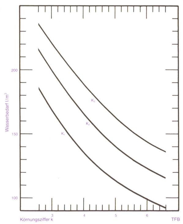
Abb. 2 Abhängigkeit des Wasserbedarfes von Betonmischungen von der Körnungsziffer des Zuschlages.  $K_1 = \text{weichplastische}, \ K_2 = \text{plastische}, \ K_3 = \text{steifplastische} \ \text{Konsistenz}.$
