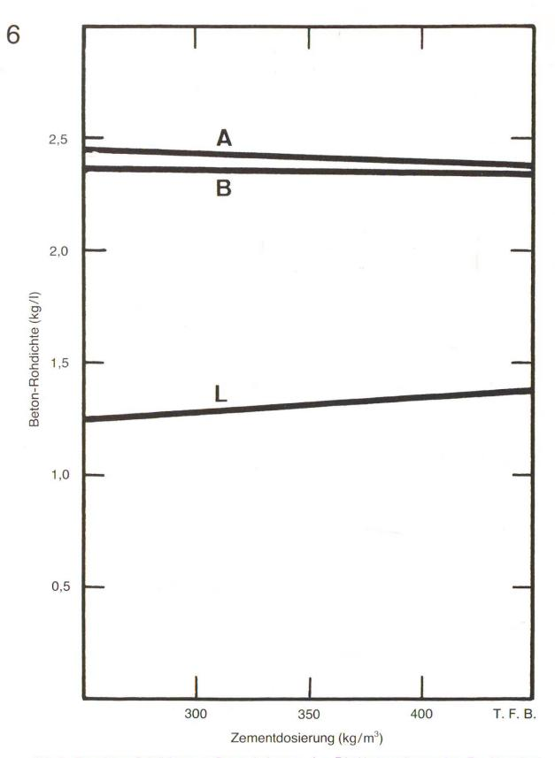
Abb. 3 Berechnete Rohdichten von Betonmischungen. A = Frischbeton mit normalem Zuschlag ohne und (B =) mit Lufteinschlüssen. L = Frischbeton mit Leichtzuschlag.
