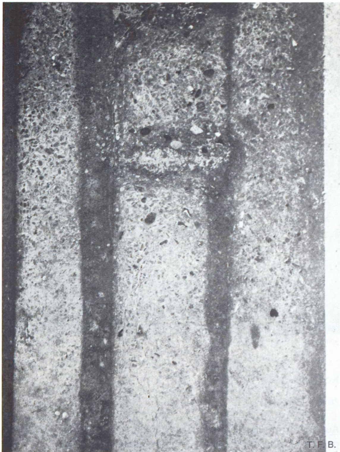
Abb. 10 Geschliffener Beton mit Entmischungsschäden infolge undichter Schalung.
