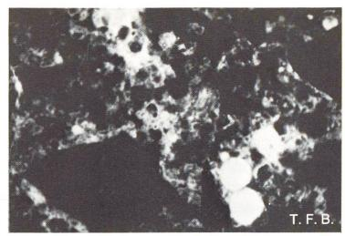
Abb. 4 Dünnschliffpräparat zeigt Luftporen mit 1/50 bis 1/10 mm Durchmesser.
