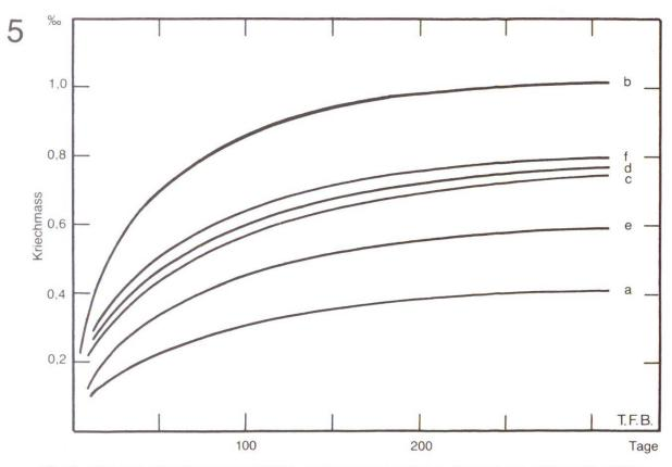
Abb. 2 Typische Kriechkurven bezüglich Ausmass und zeitlicher Entwicklung. Beton 0 bis 20 mm, PC 280 kg/m³, w = 0,6. Druckbelastung 17,5 N/mm² = etwa 35% der Druckfestigkeit. Lastaufnahme nach 35 Tagen Feuchtlagerung. Temperaturen: a) 20, b) 70, c) 120, d) 145, e) 175 und f) 230°C. Versuche von Nasser und Marzouk, s. Literaturangabe.
