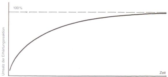
Abb. 2 Der zeitliche Verlauf des Umsatzes der Erhärtungsreaktion.
