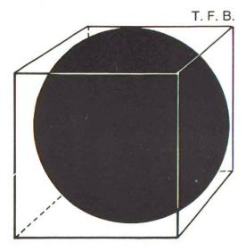
Abb. 2 Räumliche Verhältnisse von Wasser-Zement-Gemischen vor und nach der Hydratation. Die Kugeln stellen den Festraum des Zementes bzw. der Hydrate dar, der durchsichtige Teil der Würfel ist das zugegebene Wasser bei Wasser: Zement = 1:2, Wasserzementwert = 0,5. Bei der Hydratation verdoppelt sich der Raumanteil der Feststoffe, während sich das Gesamtvolumen um etwa 7,5 % verkleinert (s. auch «CB» 77/16).
