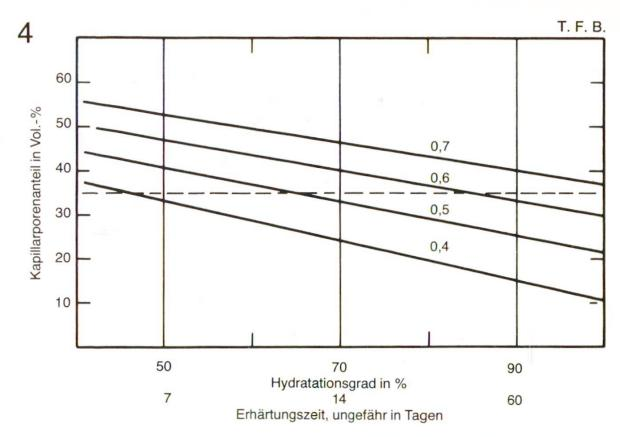
Abb. 3 Kapillarporenanteil im Zementstein je nach Hydratationsgrad und Wasserzementwert. Berechnung. Die gestrichelte Linie zeigt den Übergang zum durchgehend verbundenen Kapillarporensystem. Wasserzementwert 0,4, 0,5, 0,6 und 0,7.
