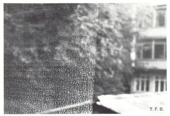
Abb. 2 Ansicht der gleichen Fensterscheibe wie in Abbildung 1, jedoch nach der Reinigung der rechten Glashälfte mit stark verdünnter Flusssäure und Nachwaschen mit Wasser. Das so behandelte Glas hat seinen ursprünglichen Zustand zurückerhalten.
