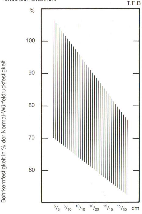
Bohrkerndurchmesser / Bohrkernhöhe
