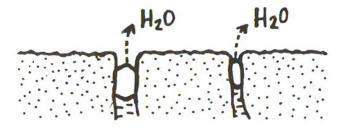
Abb. 7 Bei trockener Witterung verdunstet das ausdringende Kapillarwasser bereits unterhalb der Betonoberfläche. Der dabei auskristallisierende Kalk verstopft die Porenmündungen. Das ist ein Grund dafür, dass Beton nach einigen Wochen der freien Exposition keinen Kalk mehr ausscheiden kann.
