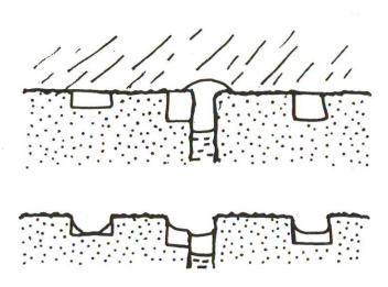
Abb. 9a/b Regenwasser, das immer mehr oder weniger sauer reagiert, löst Calciumkarbonat langsam auf. Dünne Kalkbeläge verschwinden innert einiger Jahre. Bewitterter Beton wird dunkler und in seiner Farbe ausgeglichener.
