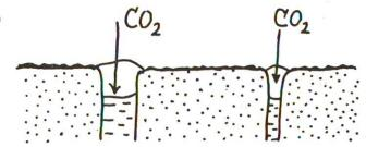
Abb. 8 Die Kohlensäure der Luft kann gelösten Kalk im Innern des Zementsteins nahe der Oberfläche karbonatisieren. Unlösliches Calciumkarbonat wird ausgeschieden und verschliesst die Porenmündungen. Es besteht die gleiche Wirkung wie bei Abb. 7.
