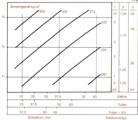
Abb. 1 Für Beton mit 35 N/mm² nach 28 Tagen – mittlere Würfeldruckfestigkeit.
