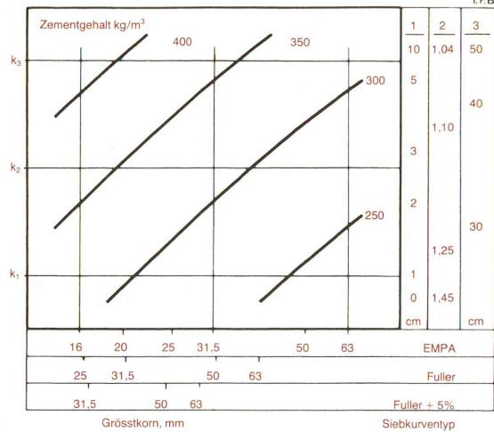
Abb. 2 Für Beton mit 45 N/mm² nach 28 Tagen – mittlere Würfeldruckfestigkeit.
