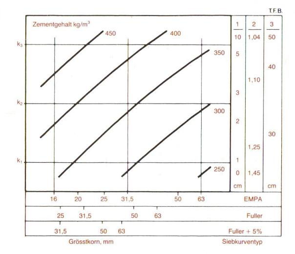
Abb. 3 Für Beton mit 55 N/mm² nach 28 Tagen – mittlere Würfeldruckfestigkeit.
