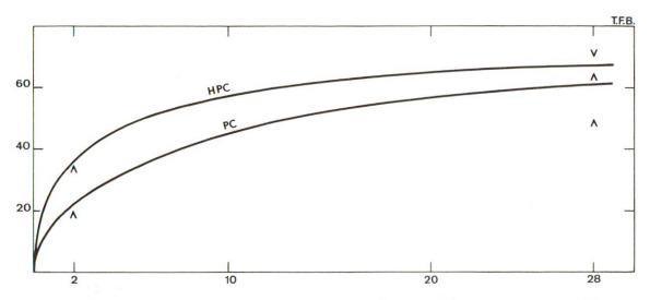
Abb. 1 Zunahme der Normendruckfestigkeit von PC und HPC in den ersten 28 Tagen. Eingezeichnet sind
