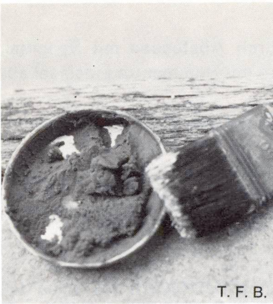
Abb. 3 Mit Bentonit und Trichloräthan wird eine Adsorptionspaste hergestellt.
