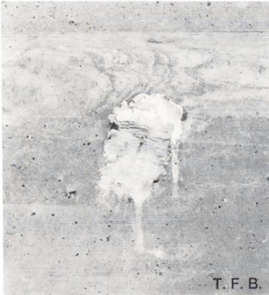
Abb. 5 Die Adsorptionspaste ist eingetrocknet. An den Stellen, wo sie Bitumen aufgenommen hat, ist sie dunkelbraun gefärbt.
