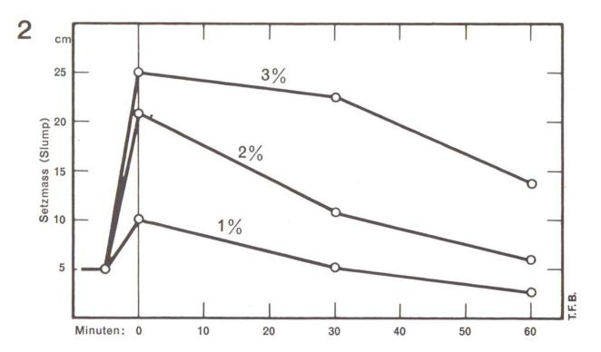
Abb. 1 Wirkung der Fliessmittelzugabe von 1–3% und zeitliche Abnahme der Verflüssigung (nach Malhorta, s. Literaturangabe). Im übrigen erfolgt die Versteifung um so rascher, je höher die Temperatur des Frischbetons ist.
