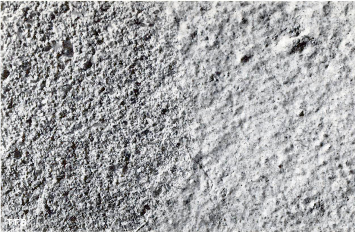
Abb. 1 Abgeätzte Kalkschicht an einer glatten Betonoberfläche, vergrößert, Bildbreite = 10 mm. Links sind etwa 2 \text{ mg/cm}^2 \text{ CaCO}_3 aufgelöst worden.
