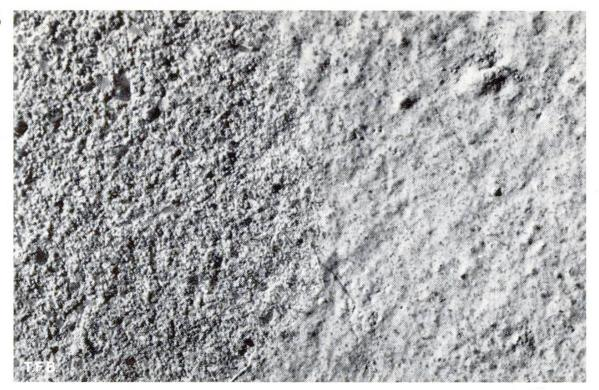
Abb. 1 Abgeätzte Kalkschicht an einer glatten Betonoberfläche, vergrössert, Bildbreite = 10 mm. Links sind etwa 2 mg/cm² CaCO<sub>3</sub> aufgelöst worden.
