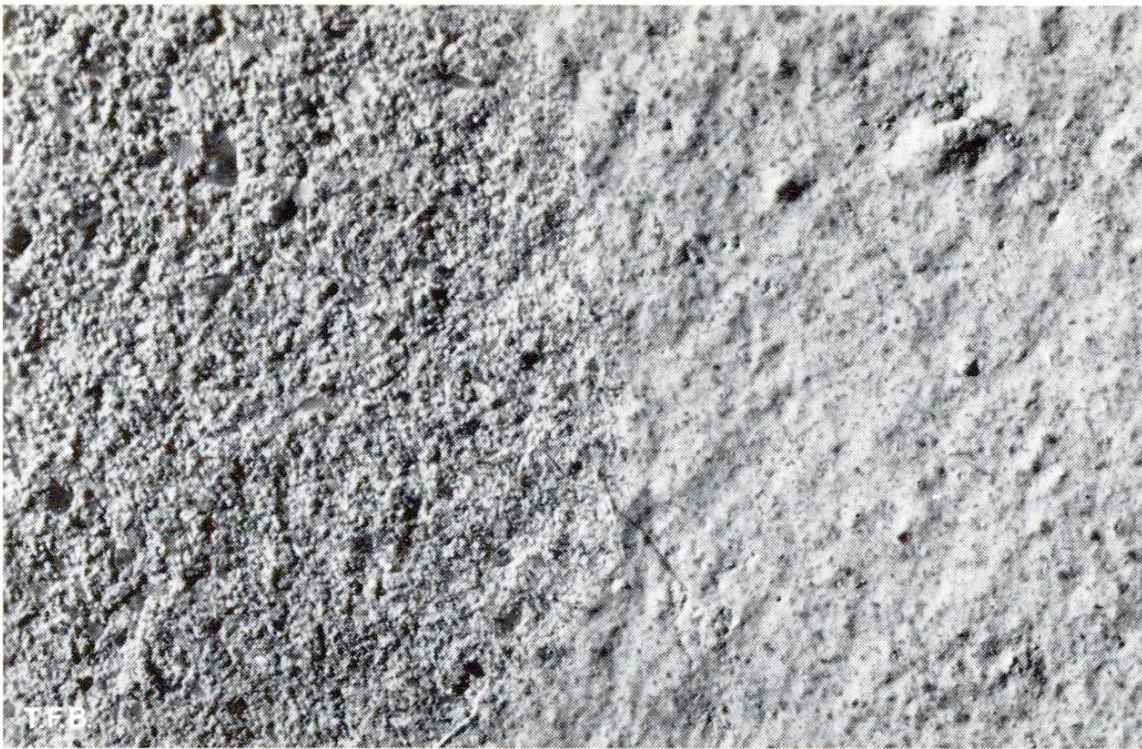
Abb. 1 Abgeätzte Kalkschicht an einer glatten Betonoberfläche, vergrößert, Bildbreite = 10 mm. Links sind etwa 2 \text{ mg/cm}^2 \text{CaCO}_3 aufgelöst worden.
