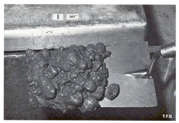
Abb. 2 Beton P 300, W/Z 0.50 nach 30 sec Mischzeit. Zuschlag nicht vollständig umhüllt. Starke Wasserausscheidung.
