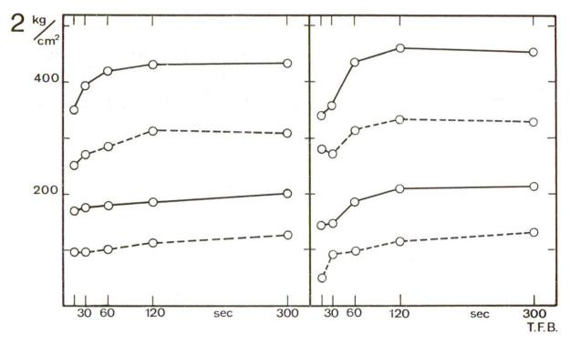
Abb. 1 Druckfestigkeiten von zwei Betonmischungen in Abhängigkeit der Mischzeit. gestrichelt: P 300, W/Z 0.65, ausgezogen: P 350, W/Z 0.50
