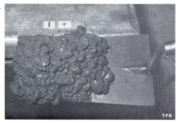
Abb. 3 Gleicher Beton wie Abb. 2 nach 180 sec Mischzeit. Mischung hält besser zusammen. Keine Wasserausscheidung.
