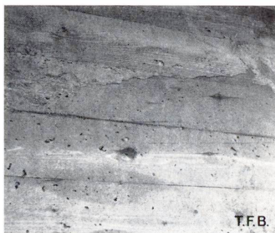
Abb. 6 Unter Druck nachgebende Schalung
