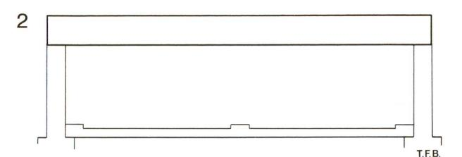
Abb. 1 Schematische Zeichnung des Querschnittes der Autobahnunterführung. Die 1,6 m starke Decke hat 10 bis 20 m Erdüberdeckung zu tragen. Sie wurde abschnittsweise in drei Lagen zu 0,50 bis 0,55 m Dicke betoniert.
