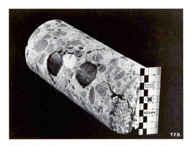
Abb. 3 Ein 90-mm-Bohrkern zeigt den Risseverlauf in der Tiefe. Am Spalt zwischen dem Beton und der Unterseite des unteren Bewehrungsstabes konnte das Ausmass der Senkung mit 2 bis 3 mm gemessen werden.
