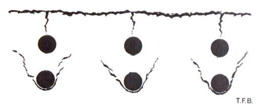
Abb. 4 Die typischen Risse, welche eine Absenkung der plastischen Betonmasse gegenüber dem Bewehrungssystem anzeigen. Durchmesser der Armierungsstäbe 30 mm.
