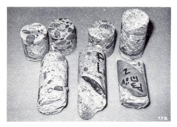
Abb. 2 Bohrkerne aus dem alten Bau aus den Jahren 1910 bis 1930. Man erkennt die unregelmässige Granulometrie mit zum Teil übergrossen Steinen.
