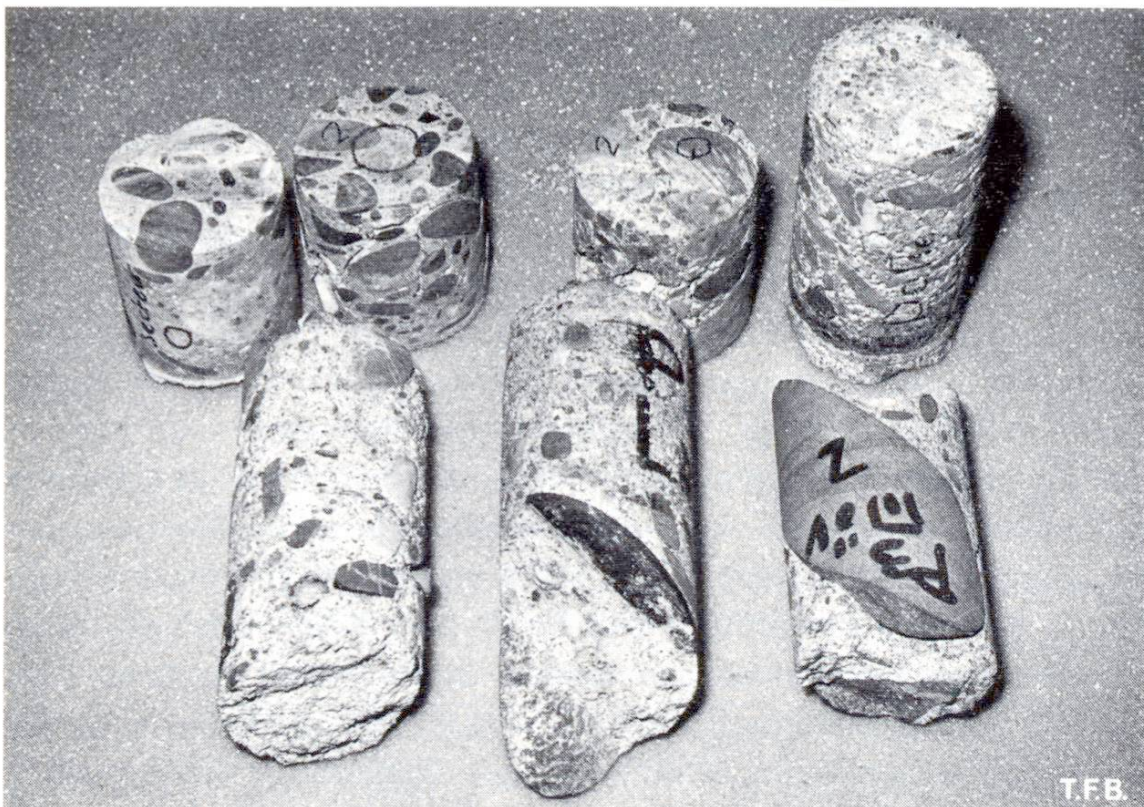
Abb. 2 Bohrkern aus dem alten Bau aus den Jahren 1910 bis 1930. Man erkennt die unregelmässige Granulometrie mit zum Teil übergrossen Steinen.
