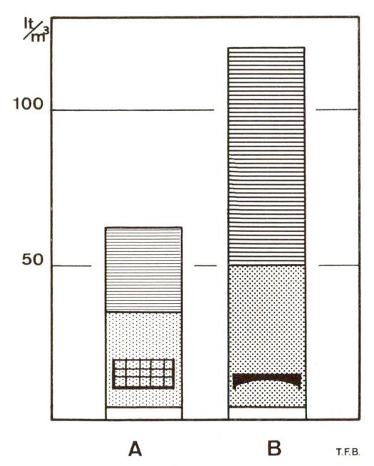
Abb. 1 Mittlerer Energiebedarf in Liter Öl pro m³ Beton. A: in Gebäuden, B: in Brücken (schraffiert: Bewehrung, punktiert: Beton, weiss: Transporte) (nach Beijer).
