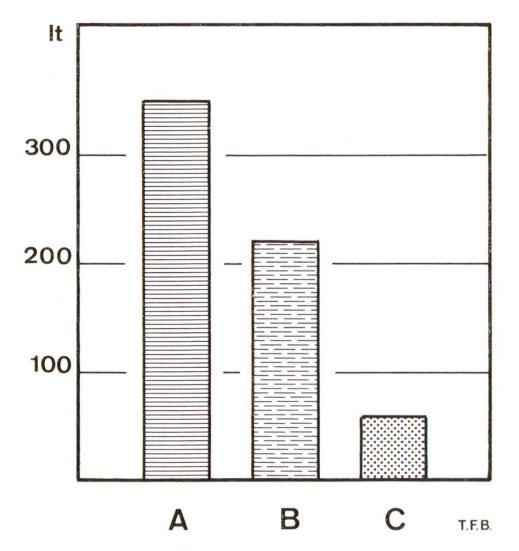
Abb. 2 Energiebedarf (in Liter Öl) einer 1 m hohen Säule mit 1000 t Tragkraft, A: aus Stahl, B: aus Backstein, C: aus Beton (nach Beijer).
