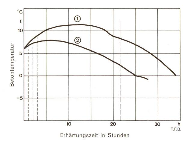
Abb. 2 Aus dem Temperaturverlauf des eingebrachten Betons lässt sich der Zeitpunkt der Erlangung der Gefrierfestigkeit ermitteln. Man berechnet die Fläche unter der Kurve bis hinab auf –10 °C von Stunde zu Stunde. Die Summe dieser senkrechten Streifen ergibt die Reifezahl.
