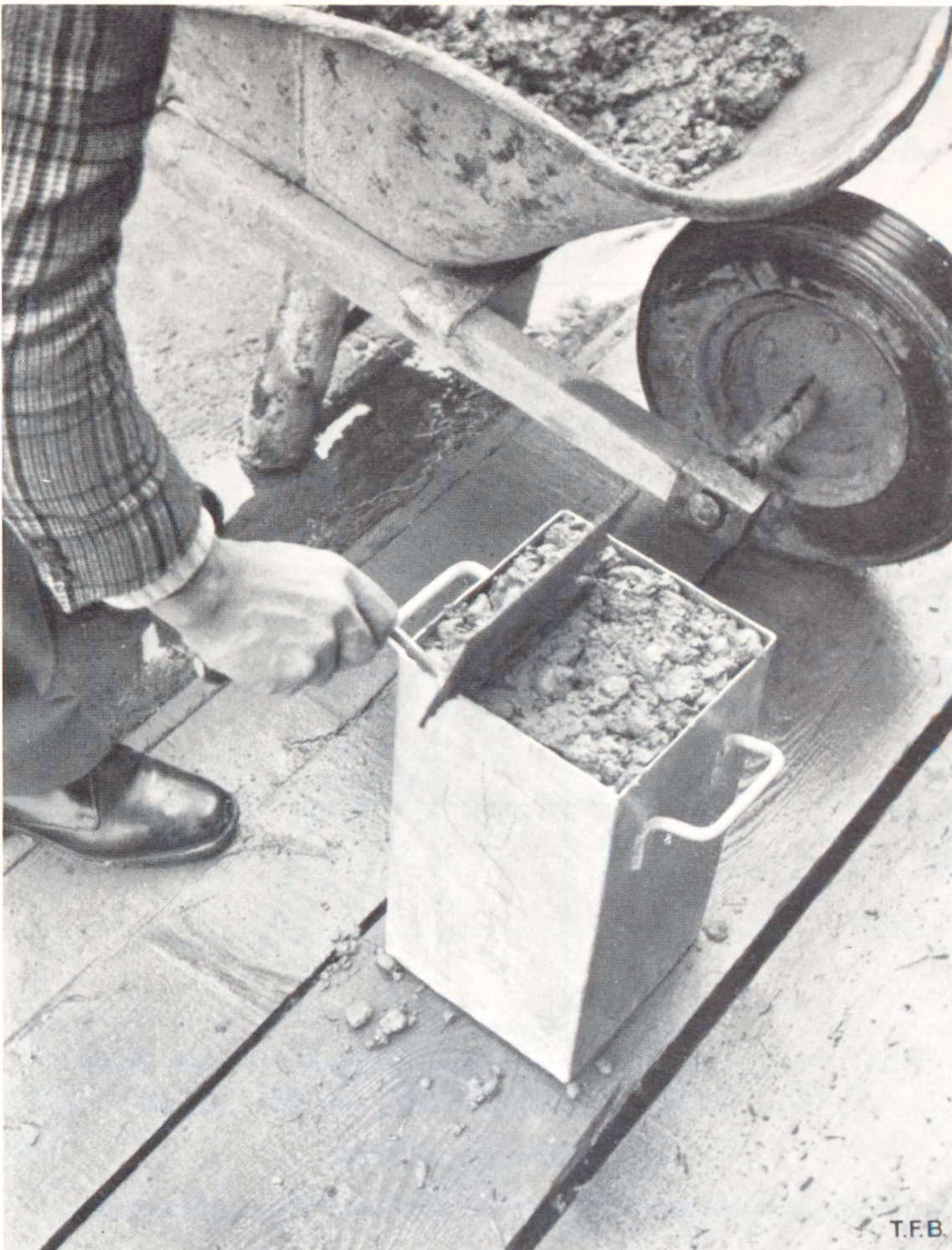
Abb. 6 Bestimmung des Verdichtungsmasses. Das Spezialgefäß 200 \times 200 \times 400 mm wird lose mit Beton gefüllt.
