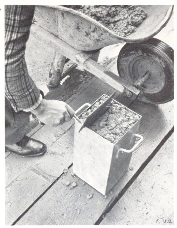
Abb. 6 Bestimmung des Verdichtungsmasses. Das Spezialgefäss  $200 \times 200 \times 400$  mm wird lose mit Beton gefüllt.
