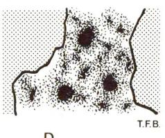
Abb. 1 Schematische Darstellung des Abbindevorganges. Bei der Wasseranlagerung entstehen voluminöse Gelmassen, welche in die wassergefüllten Zwischenräume hineinwachsen und sich zusammenschliessen. Die äussersten Gelschichten, die im Kontakt mit dem Wasser stehen, sind weich und nachgiebig, die inneren, im Bereich des Zementkornes, sind hart und
