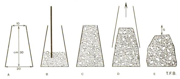
Abb. 1 **Slumptest, Setzungsmass** In einem kegelstumpfförmigen Blechrohr mit bestimmten Abmessungen (A) wird Beton in drei Schichten eingebracht und mit 25 Stössen mit einem Eisenstab verdichtet (B). Der Beton wird oben eben abgestreift (C), worauf man die Form senkrecht wegzieht (D). Der Betonkörper sinkt selbständig ein. S entspricht dem anzugebenden Setzungsmass (E).
