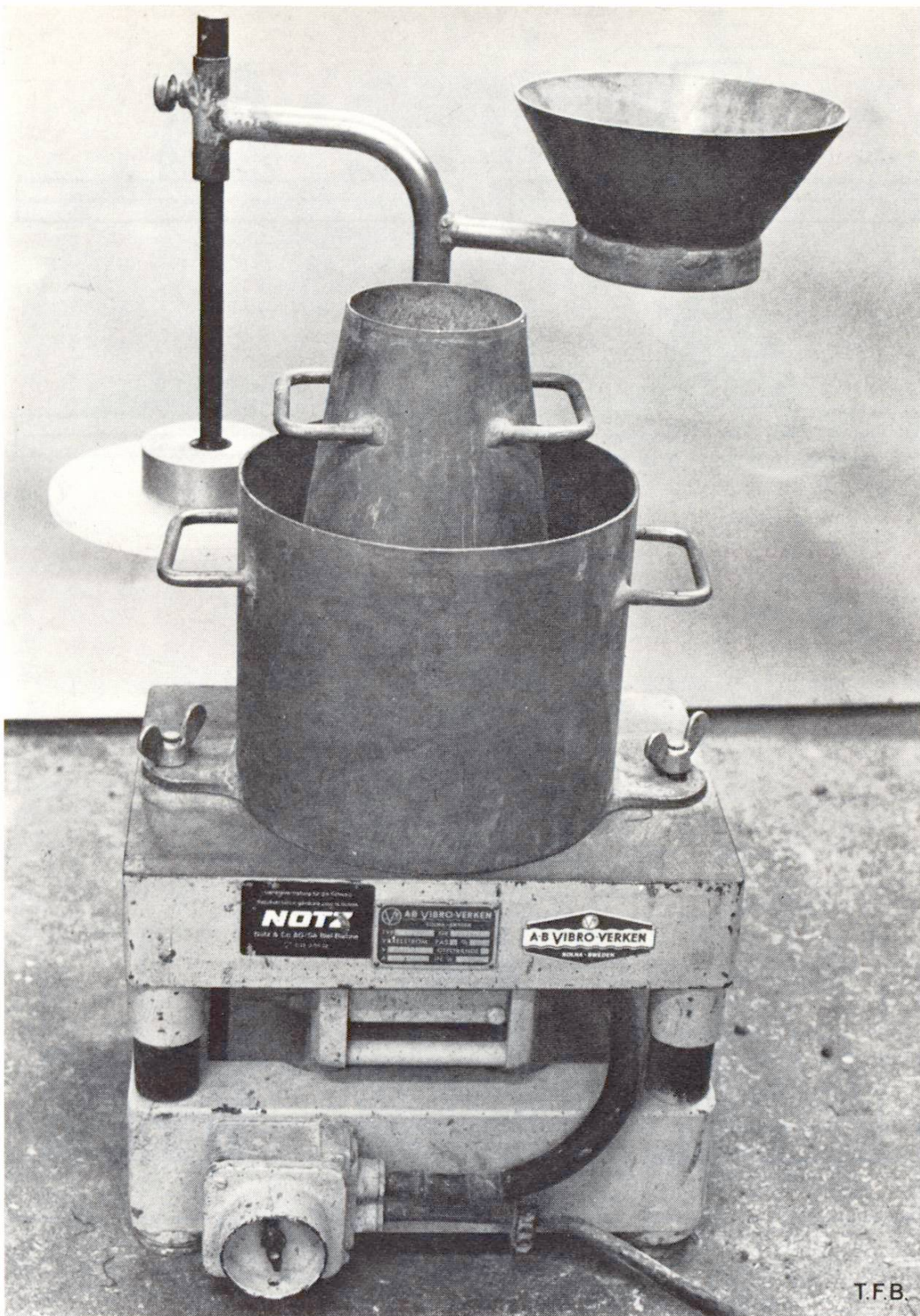
Abb. 7 Vebe-Test. Zylinderförmiges Gefäß auf Vibrationstisch, hineingestellt die Form zur Erstellung des Betonprobekörpers. Dahinter, schwenkbar an einer Achse, ein Trichter zum Einfüllen und die aufzusetzende durchsichtige Scheibe.
