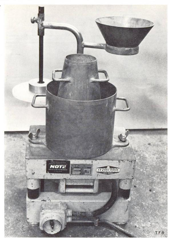
Abb. 7 Vebe-Test. Zylinderförmiges Gefäss auf Vibrationstisch, hineingestellt die Form zur Erstellung des Betonprobekörpers. Dahinter, schwenkbar an einer Achse, ein Trichter zum Einfüllen und die aufzusetzende durchsichtige Scheibe.
