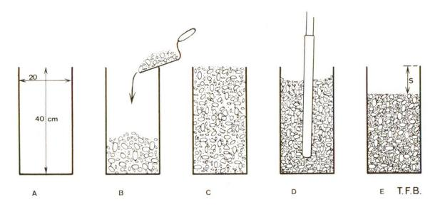
Abb. 2 **Verdichtungsmass** In ein stabiles Gefäss mit quadratischer Bodenfläche  $20\times 20$  cm und ebenen Seitenflächen  $20\times 40$  cm (A) wird Beton lose eingefüllt, indem man ihn in kleinen Portionen vom Rand her hineinfallen lässt (B). Der Beton wird oben eben abgezogen (C) und darauf mit einer kleinen Vibrationsnadel vollständig verdichtet (D). Das Verdichtungsmass entspricht dem Verhältnis der Betonvolumen vor und nach dem Verdichten und errechnet sich somit:
