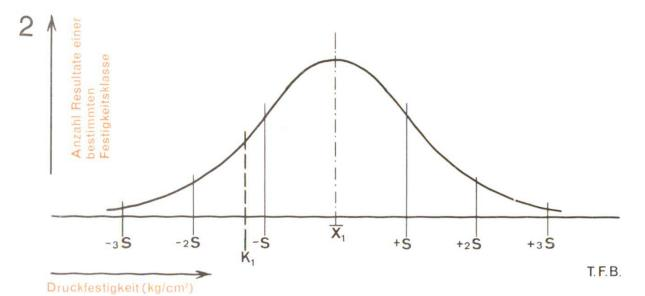
Abb. 1 Die «Gauss'sche Glockenkurve» entsteht, wenn man die Anzahl Prüfresultate, die einer bestimmten Festigkeitsklasse zufallen (z.B. zwischen 280 und 290 kg/cm² liegen) in der senkrechten Achse aufträgt. Die Kurve zeigt somit die zahlenmässige Verteilung der Prüfresultate, die sich um ihren Mittelwert  $\overline{x}$  häufen. S entspricht der Standardabweichung vom Mittelwert. Sie berechnet sich mit der Formel:
