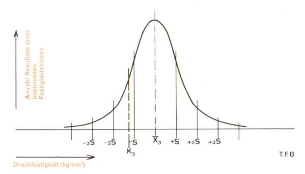
Abb. 4 Ein Beton mit kleiner Festigkeitsstreuung zeigt eine hohe, schmale Verteilungskurve der Prüfresultate. Die Einzelwerte scharen sich näher um ihren Durchschnittswert, und der Abstand des Nennwertes K ist entsprechend kleiner.
