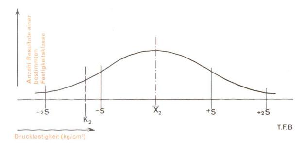
Abb. 2 Verteilungskurve der Prüfresultate eines Betons mit grosser Festigkeitsstreuung. Die Schwelle K (10% kleiner –90% grösser) ist vom Mittelwert weiter entfernt als bei der Verteilung in Abb. 1.
