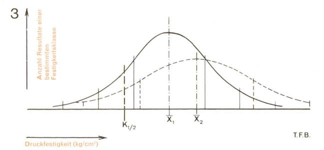
Abb. 3 Bei gleichem Nennwert K (z.B. nur 10% der Prüfresultate dürfen 270 kg/cm² unterschreiten) muss bei einem Beton mit hoher Festigkeitsstreuung (Abb. 2) ein entsprechend höher liegender Mittelwert angestrebt und gefordert werden als bei einem Beton mit kleinerer Qualitätsschwankung (Abb. 1).
