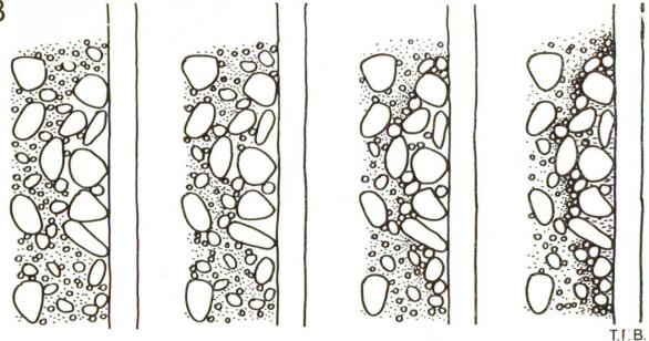
Abb. 2 Beim Zufliessen eines Kiesnestes während der Rüttelung kann sich ein Korngerüstfilter aufbauen, indem die zudrängenden Körner die bestehenden Lücken verstopfen. In diesem Falle kann zuletzt nur noch reines Wasser in den Hohlraum vordringen. Die Steine werden blankgewaschen, und das Wasser kann der Schalung entlang nach oben steigen (Abb. 7 und 8).
