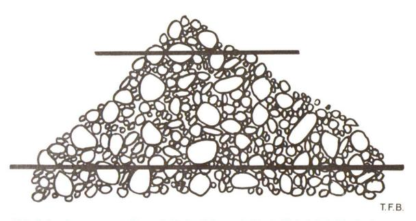
Abb. 2 In einem grossen Querschnittsbereich erscheint ein Material gleichmässiger zusammengesetzt als in einem kleinen.
