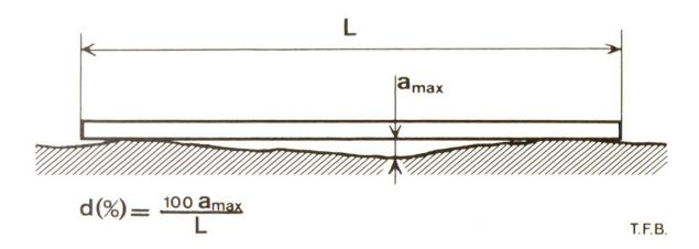
1.2 Die örtliche Ebenheit wird auf ein Lineal von 20 cm Länge bezogen, wobei die Extremwerte der kleineren Vorsprünge und Vertiefungen betrachtet werden (Abb. 2). Die gemessenen Höhenunterschiede sollten höchstens betragen:
