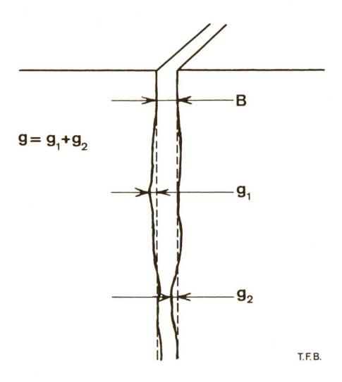
Geraden zusammen (Abb. 4). Es wird in mm oder in Relation zur mittleren Fugenbreite B angegeben, wobei der kleinere zutreffende Wert gilt. Die Abweichungen von der Sollbreite sollten höchstens betragen:
