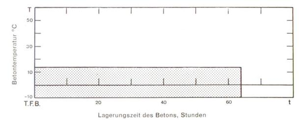
Abb. 2 Bei gleichbleibender oder bei Angabe einer durchschnittlichen Betontemperatur ist die Bestimmung der Reifezahl einfach. Im Beispiel:  $R=64~(14+10)=1536~^{\circ}C$  · Std.
