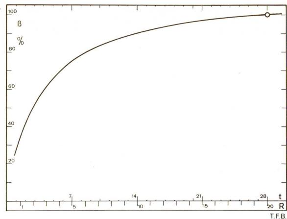
Abb. 4 Normalkurve der Festigkeitsentwicklung eines Baustellenbetons P 300 bei gleichbleibender Temperatur von 20 °C, ausgedrückt in % der 28-Tage-Normalfestigkeit. t = Erhärtungszeit in Tagen R = Reifezahl in °C · Std · 1000
