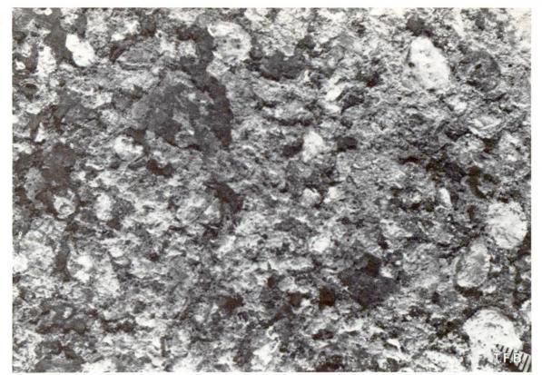
Abb. 7 Betonoberfläche ähnlich Abb. 4 nach der Behandlung. Wenige Reste des Gummiabriebes verbleiben in den Vertiefungen der Betonoberfläche.
