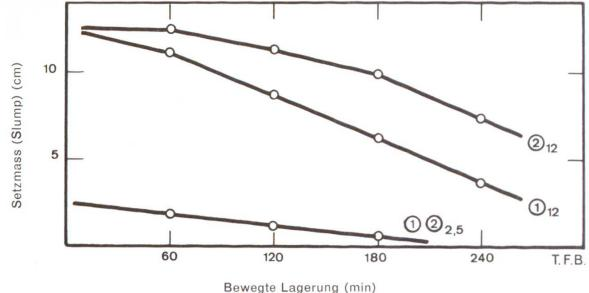
Abb. 4 Versteifung des Betons bei bewegter Zwischenlagerung, gemessen am Setzungsmass (Slump).
