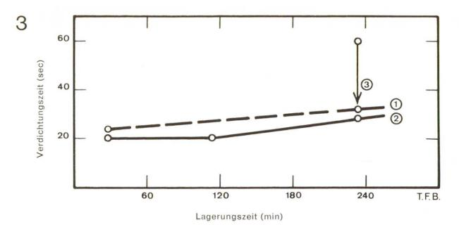
Abb. 2 Veränderung der Betonkonsistenz bei ruhender abgedeckter Lagerung, gemessen an der Zeit, die für die vollständige Verdichtung eines 20-cm-Würfels mit Innenrüttler (32 mm/2800) erforderlich war.
