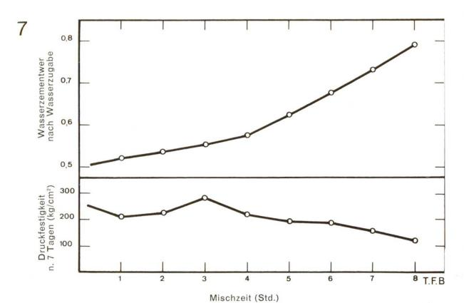
Abb. 6 Veränderung des Betons bei Dauermischung bis zu 8 Stunden. Ausgangsmischung mit 300 kg  $PC/m^3$ , Slump = 9 cm, weichplastisch). Nach jeweils einer Stunde Mischzeit wurde Wasser zugefügt, um die ursprüngliche Konsistenz wieder herzustellen. Von dieser «aufgefrischten» Mischung wurde dann eine Probe zur
