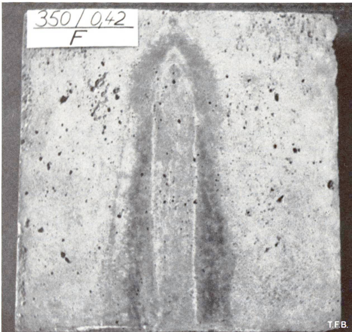
Abb. 3 Versuch über die Grautonbildung bei stetiger Zuleitung eines Wasserstromes auf eine frisch ausgeschaltete Betonfläche. Im Bereich des fließenden Wassers ist die Grautönung etwas dunkler als im rascher ausgetrockneten Feld. Dazwischen liegt eine sehr dunkle Zone, die sich unter einem nichtfließenden dünnen Wasserfilm ausgebildet hat.
