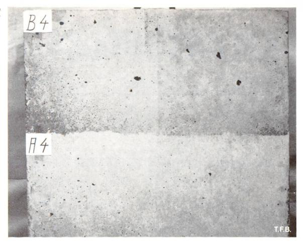
Abb. 1 Versuche zur Grautonbildung mitzweißetonmischungen und verschieden raschem Austrocknen.
