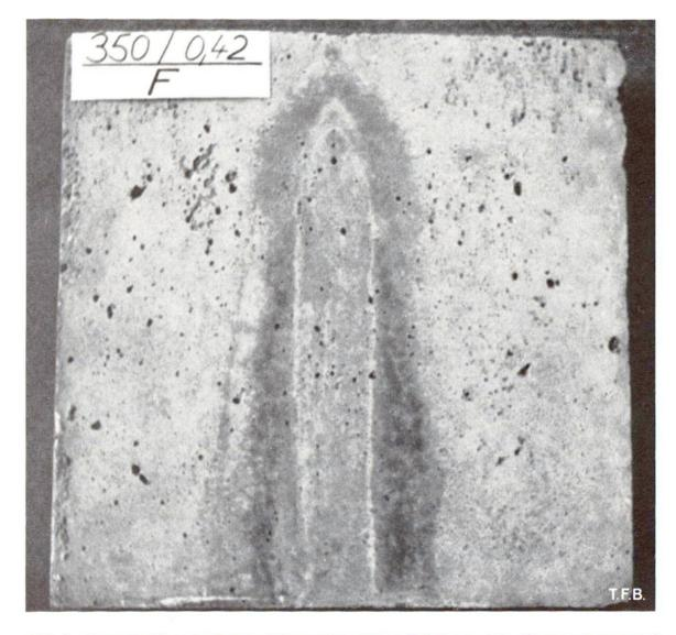
Abb. 3 Versuch über die Grautonbildung bei stetiger Zuleitung eines Wasserstromes auf eine frisch ausgeschalte Betonfläche. Im Bereich des fliessenden Wassers ist die Grautönung etwas dunkler als im rascher ausgetrockneten Feld. Dazwischen liegt eine sehr dunkle Zone, die sich unter einem nichtfliessenden dünnen Wasserfilm ausgebildet hat.
