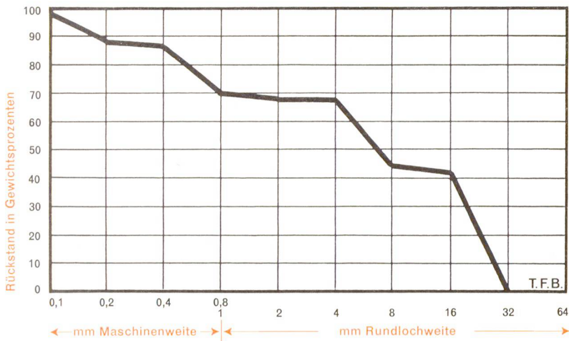
Abb. 4 Siebkurve eines Korngemisches mit fehlenden Korngruppen in drei Bereichen
