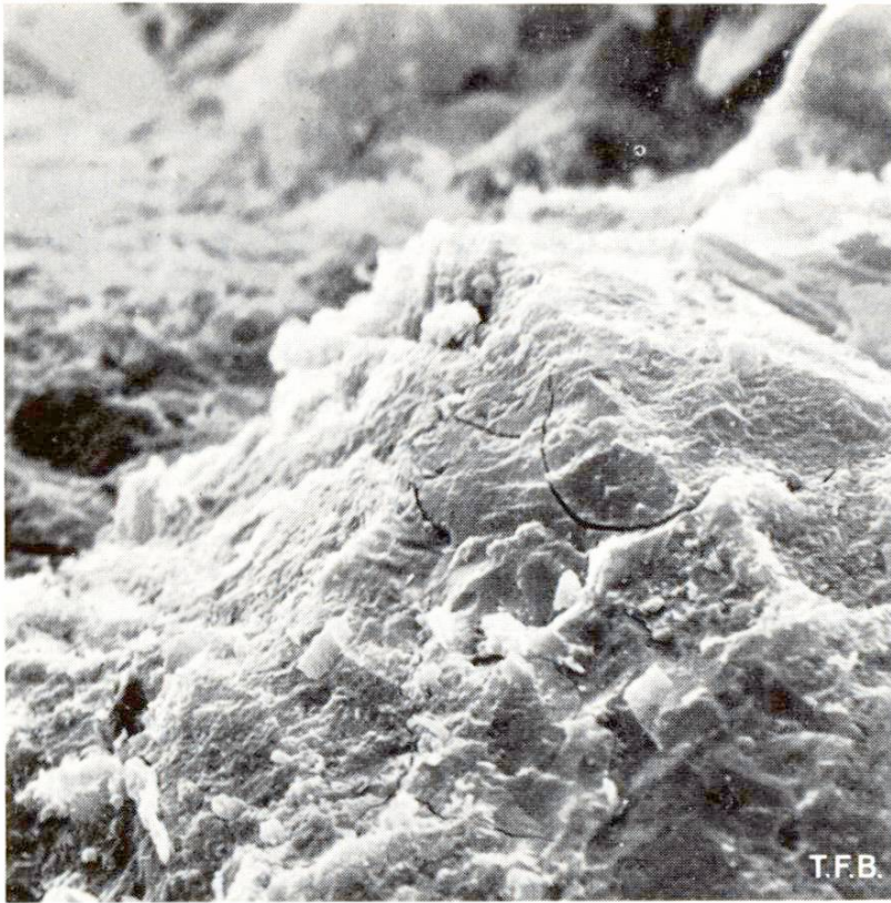
Abb. 5 Detail aus Bild 4 in 2200facher Vergrößerung. Die netzförmig verlaufenden Schwindrisse werden besser sichtbar.
