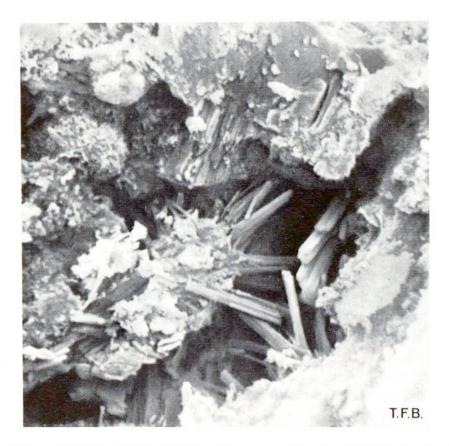
Abb. 2 Detail aus Bild 1 in 5500facher Vergrösserung. Es zeigt deutlich den in allen Richtungen mit Tobermorit-Nadeln durchwachsenen Hohlraum.
