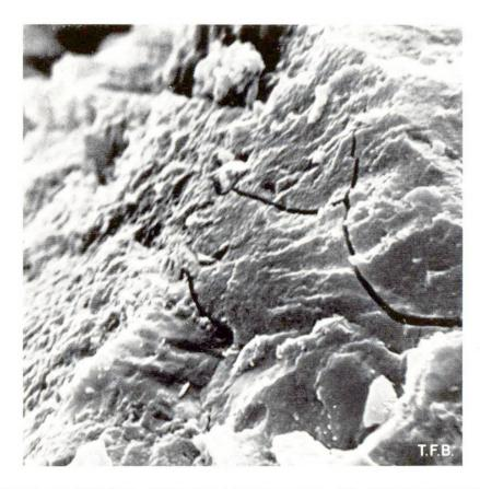
Abb. 6 Detail aus Bild 5 in 5500facher Vergrösserung. Die Schwindrisse klaffen in der Zementsteinmasse, ihre Breite beträgt indessen nur ca. 1/5000 Millimeter, d.h. 0,2 µm.
