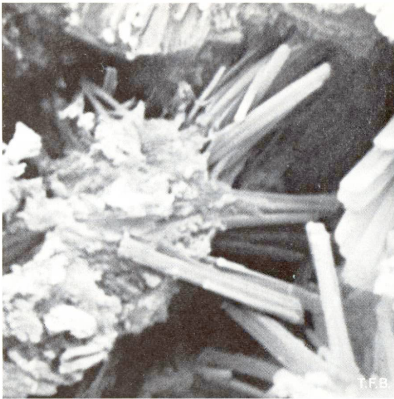
Abb. 3 Detail aus Bild 2 in 11 000facher Vergrösserung. In der Mitte links ein in den Hohlraum ragendes Zementkörnchen, mit weisslichen Hydratationsprodukten ohne gute Kristallformen umhüllt. Von letzteren aus wachsen die Tobermoritkristalle spiessig in den Hohlraum hinein, andere Nadeln wachsen ihnen entgegen, bis schliesslich der ganze Hohlraum filzig verwachsen ist.
