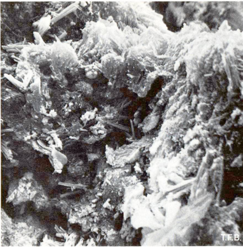
Abb. 1 Rasterelektronenmikroskop-Aufnahme der Bruchfläche einer sandfreien Zementmörtelprobe (Plättchenprobe für Raumbeständigkeitsprüfung nach SIA, ungedarrt, 3 Monate alt), im Hochvakuum goldbelegt. Vergrößerung 2500fach linear. Die Aufnahme zeigt geöffnete Hohlräume, mit faserig-nadeligen Kriställchen durchwachsen, welche nach analogen Formen bei reinem, hydratisierten Tricalciumsilikat ( C_3S ) zu schliessen, eine Tobermorit-Art sein müssen.
