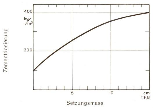
Abb. 2 Abhängigkeit der Betonkonsistenz («Slump»-Setzungsmass in cm) von der Zementdosierung ( $kg/m^3$ ) bei gleichbleibendem Wasserzementwert, W/Z=0,48. Gültig für einen bestimmten Zement und ein bestimmtes Zuschlagsgemisch.
