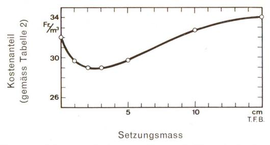
Abb. 3 Kostenoptimalisierung aus den konsistenzabhängigen Funktionen des Verarbeitungsaufwandes und der Zementdosierung bei gleichbleibender Festbetonqualität. Beispie der Abb. 1 und 2 und der Tabelle 2. Es zeigt sich ein Kostenminimum mit einem Setzmass von 2-3 cm und einer Zementdosierung von 285–300 kg/m³ (gemäss Abb. 2).
