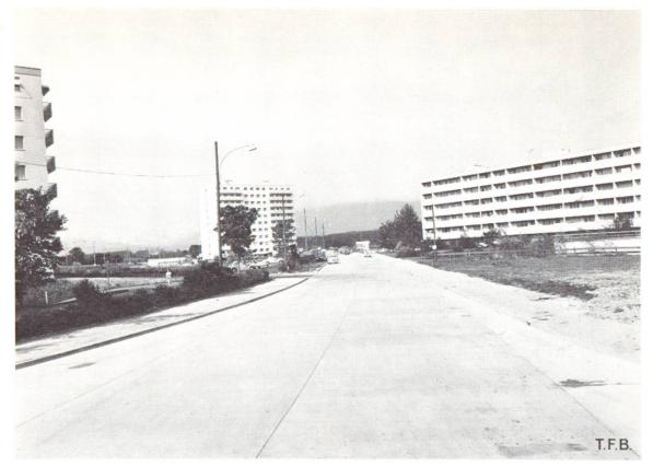
Abb. 4 Die «Avenue Pierre de Savoie» in Yverdon, 1967 erstellt, ermöglicht den Zugang zu grösseren Wohnhäusern, die ausserhalb der Stadt erstellt werden. Der Betonbelag liegt über nachgiebigem Torfboden, der vorgängig künstlich verstärkt werden musste.
