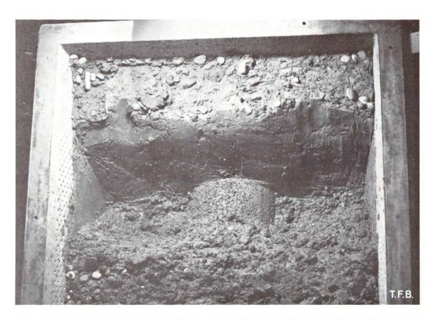
Abb. 4 Betonfilterrohr in bindigem Boden, aufgenommen nach einem Leistungsversuch an der TH Darmstadt. Nach 8 nachvollzogenen Niederschlagsperioden hat sich bei einem Wasserdruck von ca. 30 cm eine Abflussleistung von 3 Litern pro Minute und pro Laufmeter Rohr eingestellt.
