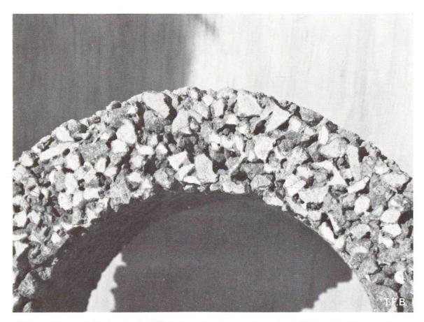
Abb. 2 Querschnitt durch ein Filterbetonrohr, der die Form und Grösse der Poren aufzeigt.
