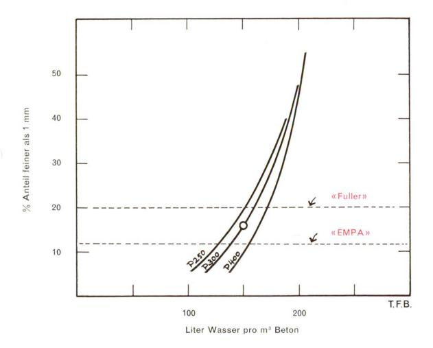
Abb. 3 Einfluss der Kornabstufung auf den Wasserbedarf von Betonmischungen. 0-30 mm Rundkorn, Zementdosierungen 250, 300 und 400 kg/m3. Verschiebt sich beim P 300 beispielsweise die Kornabstufung von der EMPA- zur Fuller-Kurve, so nimmt der Wasserbedarf um ca. 20 I zu, und der Wasserzementwert steigt dementsprechend um 0,067 Punkte an. Dies hat bereits einen Festigkeitsverlust von ca. 70 kg/cm² zur Folge.
