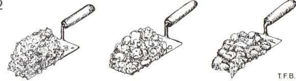
Abb. 1 Erdfeuchter, steifplastischer und plastischer Beton bei der Kellenprobe.
