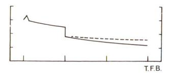
Abb. 3 Die effektiven Längenänderungen eines 10 m langen Betonbalkens oder einer 10 m hohen Betonsäule entsprechen Abb. 2. Aufnahme einer Druckbelastung von 100 kg/cm² nach einem Monat. Die totale Verkürzung in 3 Monaten beträgt ungefähr 9 mm = 900 · 10<sup>-6</sup> (Beispiel zum Aufzeigen der Grössenordnungen).
