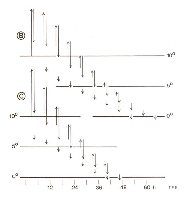
Abb. 1 Schematische Darstellung des zeitlichen Verlaufes der Abkühlung von frisch eingebrachtem Beton. Die Abkühlungskurve ist durch die nach unten gerichteten Pfeilspitzen gekennzeichnet. Dieses Beispiel lässt sich nicht auf den praktischen Fall übertragen. Grundlegende Daten wie Art der Isolation und Form des Baukörpers fehlen.
