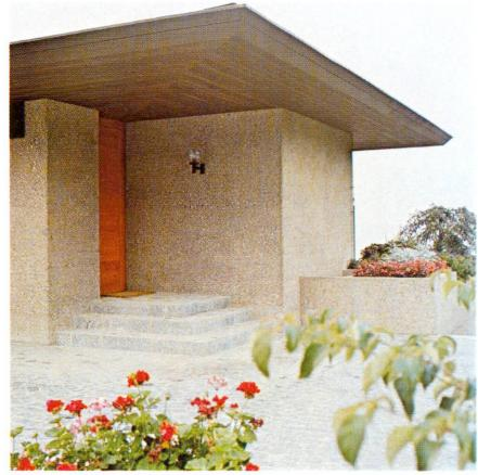
Die Fassaden geheizter Räume sind als Doppelwände mit Zwischenisolierung ausgebildet.
