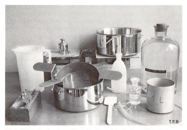
Abb. 1 Vollständige Ausrüstung für die Frischbeton-Schnellanalyse «EMPA-Canard» bestehend aus: Waage mit Gewichtssatz, 2 Stahlpfannen 22 und 24 cm Ø; Siebe 0,16 mm und 2 mm Maschenweite, 20 cm bzw. 19,5 cm Ø, beide mit Handgriffen; 1-Liter-Messgefäss, tariert für Frischbetonprobe, technischer Alkohol (etwa 1 bis 1,5 Liter pro Analyse), 10prozentige, wässrige Traubenzuckerlösung, Plastikmessbecher 2 Liter, Spritzflasche mit Alkohol; Gummischlauch mit Quetschhahn; Teigschaber.
