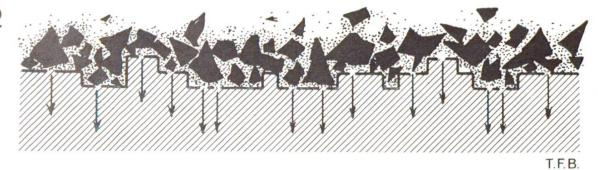
Abb. 1 Schematische Darstellung der Haftung durch Verzahnung. Die anfänglich weiche Gelmasse, welche die Zementkörnchen umgibt (punktiert), tritt in engen Kontakt mit den Unebenheiten der Schalungsfläche, besonders bei porösem Schalungsmaterial, welches im trockenen Zustand Wasser aus dem Beton aufnimmt.
