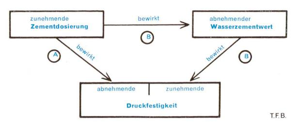
Abb. 1 Einfluss zunehmender Zementdosierung auf die Druckfestigkeit von Beton. Direkter Einfluss (A) vorherrschend bei hochfestem Beton. Indirekter Einfluss über den Wasserzementwert (B) vorherrschend bei normalem Beton.
