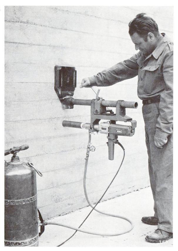
Abb. 2 Kernbohrgerät, bestehend aus Bohrständer und Bohrmaschine mit Diamantbohrer. Links: Druckgefäss für Kühlwasser mit Verbindungsschlauch zum Diamantbohrer. Elektrokabel für Anschluss an Lichtleitung oder Notstromaggregat.
