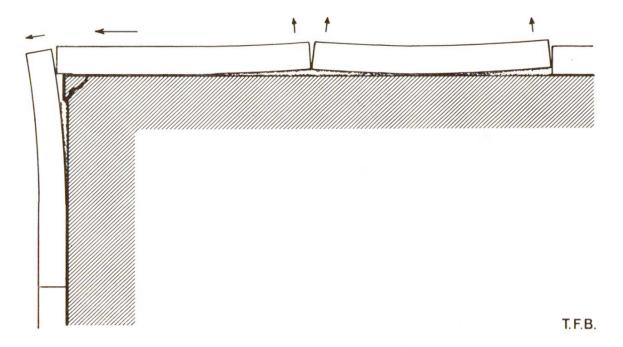
Abb. 2 Möglichkeiten der vorzeitigen Ablösung infolge quellendem Schalungsholz.
