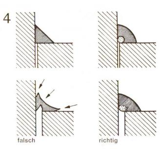
Abb. 4 Hinweis für die Verfugung mit Fugenmassen. Auch bei Eckfugen ist das Einlegen eines Schaumstoffstreifens erforderlich, da sonst bei Änderungen der Fugenbreite Risse in der Fugenmasse entstehen (Pfeile) [1].
