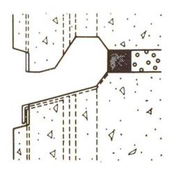
Abb. 6 Zweistufige Fugendichtung, oben: Vertikalfuge (Regendichtung durch Kunststoffprofil); unten: Horizontalfuge; Winddichtung in beiden Fällen durch Fugenmasse.
