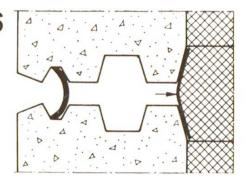
Abb. 8 Zweistufige Fugendichtung (Vertikalfuge). Als Regendichtung wird in eine zurückgesetzte Nut ein Metall- oder Kunststoffstreifen eingesetzt. Hierdurch entsteht optisch der Eindruck einer offenen Vertikalfuge. Die Winddichtung wird durch eine Folie erreicht [5].
