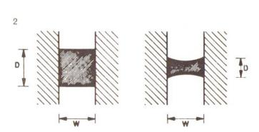
3 Schaumstoffstreifen ausgefüllt, der als «Gegenlager» für die einzubringende Fugenmasse dient. Nach Gjelsvik [1] sollen die Abmessungen der Verfugung – Breite: Tiefe – sich bei plastischen Materialien wie 1:1, bei elastischen Materialien wie 2:1 verhalten (Abb. 2). Dies ist als Faustregel zu betrachten, von der in begründeten Fällen abgewichen werden kann. (Bei sehr breiten Fugen kann die Tiefe kleiner, bei sehr engen Fugen soll sie grösser sein als dem angegebenen Verhältnis entspricht.)
