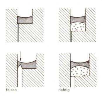
Abb. 3 Hinweis für die Verfugung mit Fugenmassen. Der «Boden» der Fuge darf die Verformung der Fugenmasse nicht behindern, sonst können bei Änderung der Fugenbreite Risse entstehen (Pfeil). Richtig ist das Einlegen eines Schaumstoffstreifens vor der Verfugung [1].
