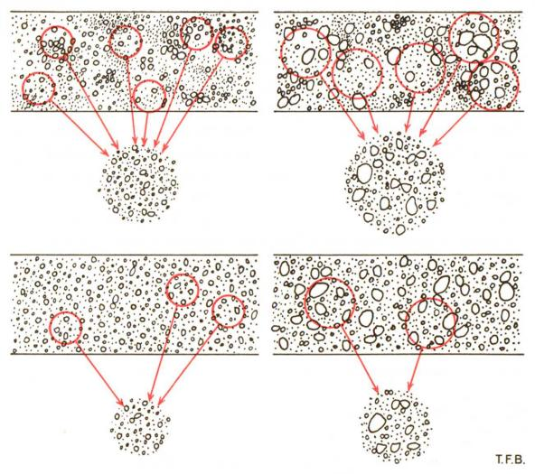
Abb. 1 Anzahl der Teilproben und Probemenge (schematische Darstellung).
