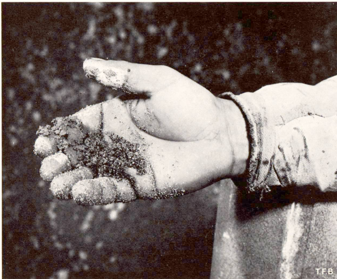
Abb. 2 Schmutziger, lehmhaltiger Sand erweist sich bei der Handprobe als schmierig und klebrig.
