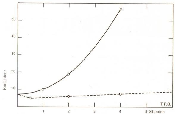
Abb. 1 Einfluss der Lagerungszeit von Portlandzement-Beton auf die Konsistenz (nach Wischers).
