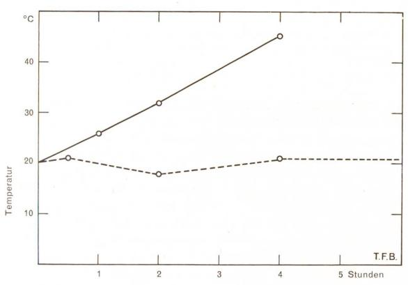
Abb. 2 Einfluss der Lagerungszeit von Portlandzement-Beton auf die Temperatur der Betonmischung (nach Wischers).
